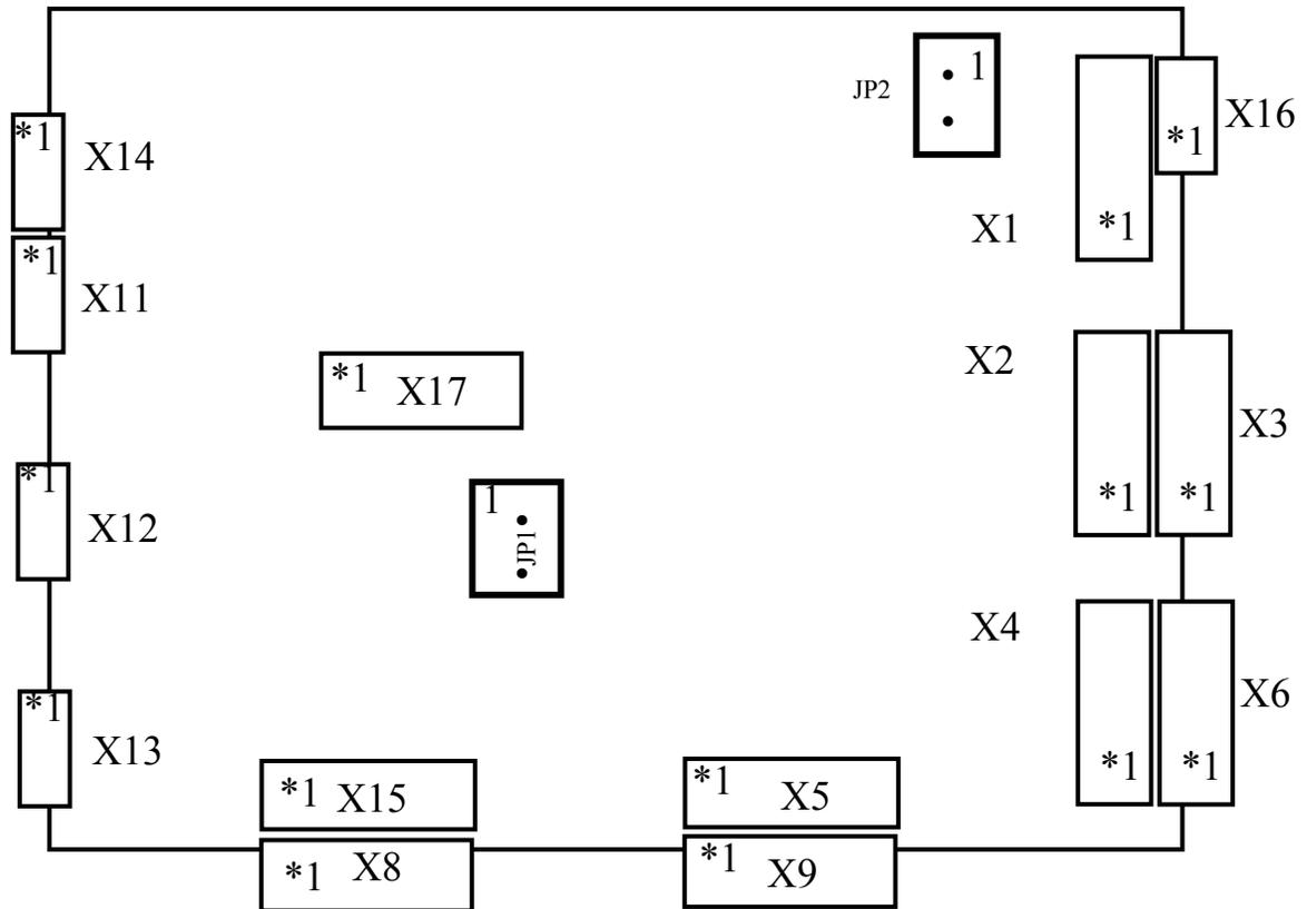
X1...X6 – разъёмы подключения датчиков температуры и аналоговых датчиков в стандарте 4...20 мА.
